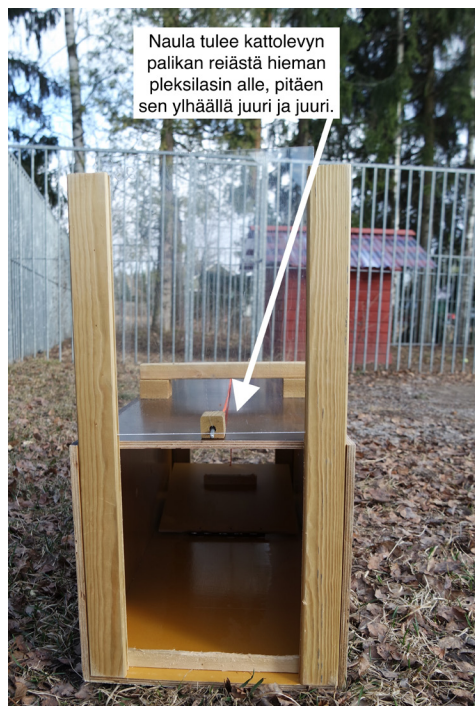
< Kuva loukun virityksestä ja teksti Naula tulee kattolevyn palikan reiästä hieman plexilasin alle, pitäen sen ylhäällä juuri ja juuri. Kuva: Pia Huusko
